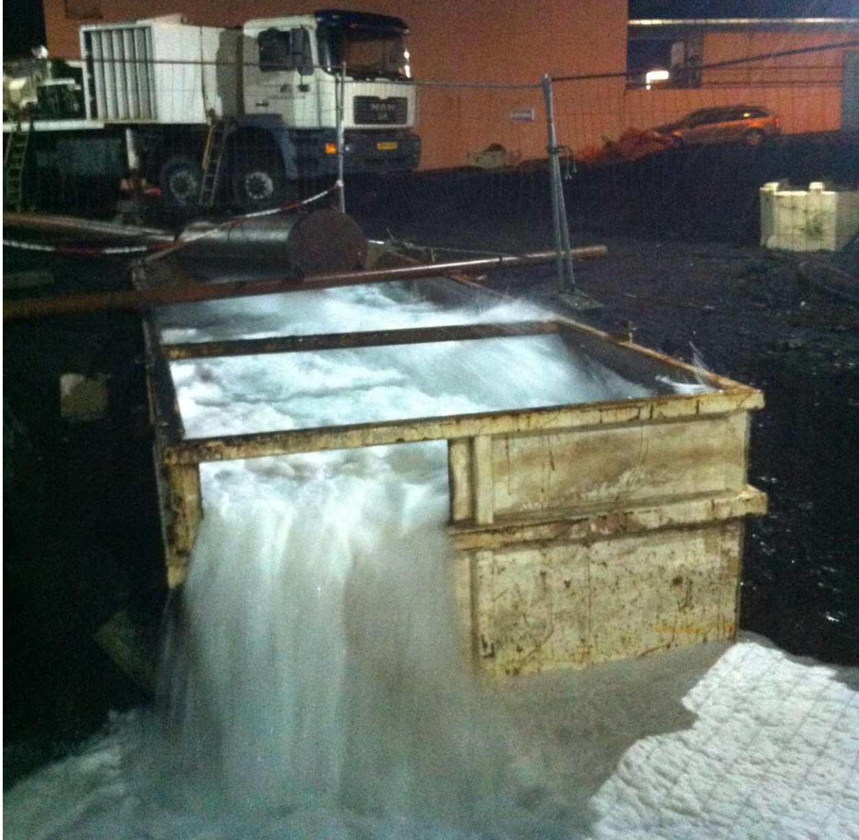
Mynd 3. Rennslismælingastaður við loftdælingu úr holu 3. Jarðsjórinn freyðir mikið og vatnshæð í yfirfallinu verður þess vegna stundum ofmetin. Einnig eru nokkrar ölduhreifingar, sem þarf að útjafna þegar mælt er. Oftast er haft mið af miðgildi vatnshæðar en samt ekki ýkt. Þarna var rennsli metið vera 220 L/s.
